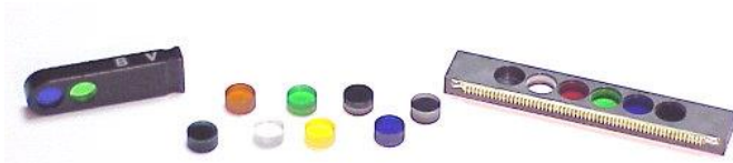
Şekil 1.15 SSP-5 ışıkölçer için kaydırmalı filtre çubuğu.
