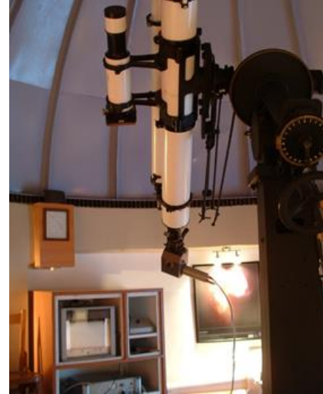
Şekil 1.10 Ege Üniversitesi Gözlemevi’nde bulunan 15 cm çaplı mercekli teleskop ve ona bağlı ışıkölçer ile yazıcı.
